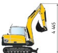
Fig. 1 : Equipamiento de trabajo pluma monobloque, con balancín de 1650 mm
